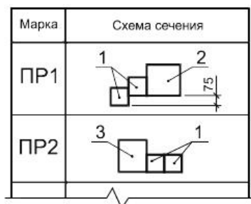
Рисунок В.1 - Пример выполнения ведомости перемычек
